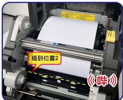
7. 将相纸插到黑板下，直到听到**哔哔声**，**再径直插入相纸**。
