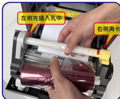
8. 将色带的**拉紧侧**装到打印机上相同颜色（黄色）支架上。
