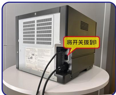
1. 连接电源和USB线，**打开电源**。
