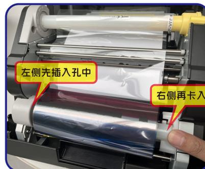
9. 将色带的**供应侧**装到打印机上相同颜色（白色）支架上。
